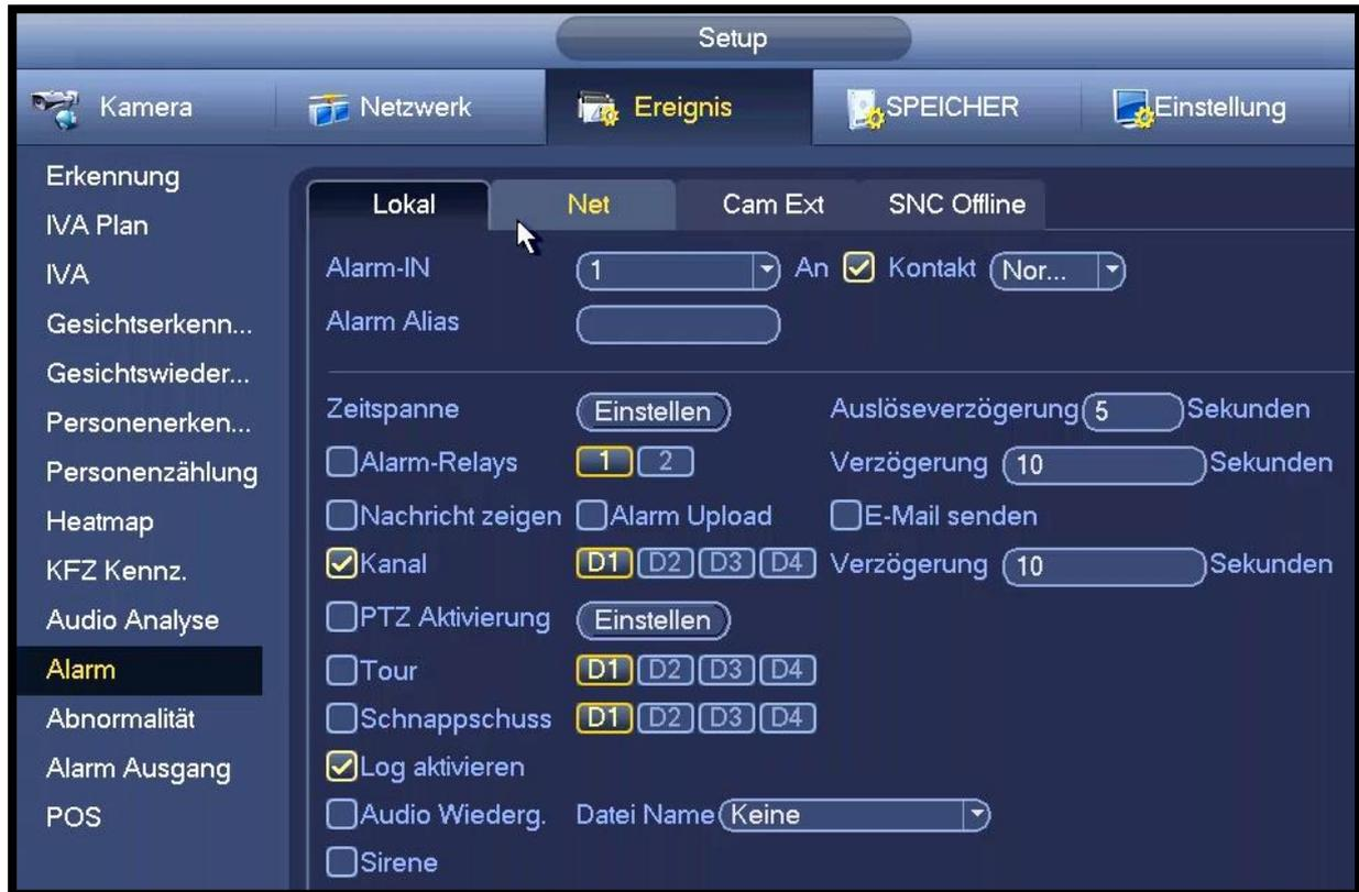
Diese Funktion bezieht sich auf die physischen Alarm-Eingänge an der Kamera. Voraussetzungen für diese Funktion sind, dass die Kamera über Alarm-Eingänge verfügt und auch mindestens ein externes Alarm-Gerät an die Kamera angeschlossen ist.
